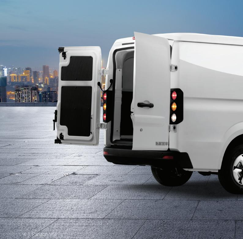
Die hintere Doppeltür mit einem Verhältnis von 4:6 kann von beiden Seiten geöffnet werden (180° / 270°).
