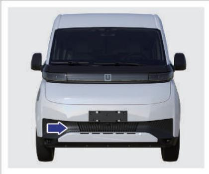
1. Entfernen Sie die vordere Abschleppösen-Abdeckung an der vorderen Stoßstange mit einem geeigneten Werkzeug.
