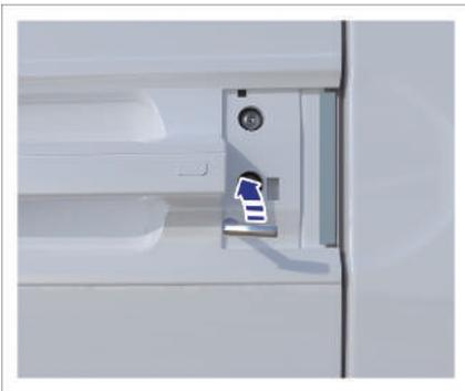
4. Schließen Sie die Fahrertür, stecken Sie den mechanischen Schlüssel in das Türschloss und drehen Sie ihn gegen den Uhrzeigersinn zur Verriegelung.
