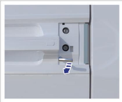
3. Stecken Sie den mechanischen Schlüssel in das Türschloss und drehen Sie ihn im Uhrzeigersinn, um das Fahrzeug zu entriegeln.
