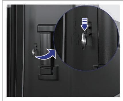
Die Schalter für die Kindersicherung befinden sich an der Kante der seitlichen Schiebetüren. Stecken Sie den mechanischen Schlüssel in das Loch der Kindersicherung und bewegen Sie ihn nach unten, um die Kindersicherung zu entriegeln. Wenn die Kindersicherung „aktiv“ ist, kann die seitliche Schiebetür nicht vom Fahrzeuginneren aus geöffnet werden. Die Türen können nur von außen geöffnet werden.
