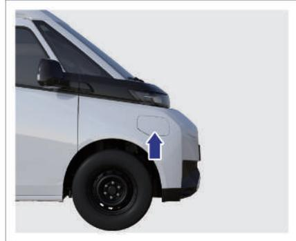
Der Ladeanschluss befindet sich am rechten vorderen Kotflügel des Fahrzeugs. Um die Ladeklappe zu öffnen, drücken Sie bei entriegeltem Fahrzeug auf die linke Seite der Ladeklappe.
