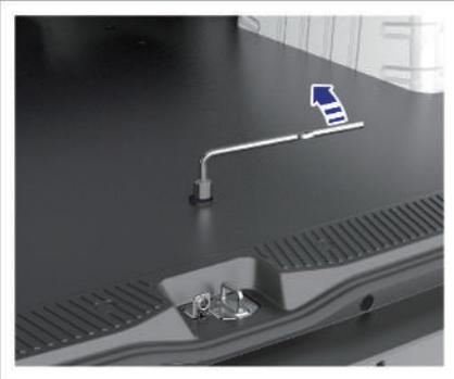
2. Drehen Sie die Halteschraube des Reserverads mit dem mitgelieferten Demontagewerkzeug gegen den Uhrzeigersinn, um das Reserverad abzusenken;
