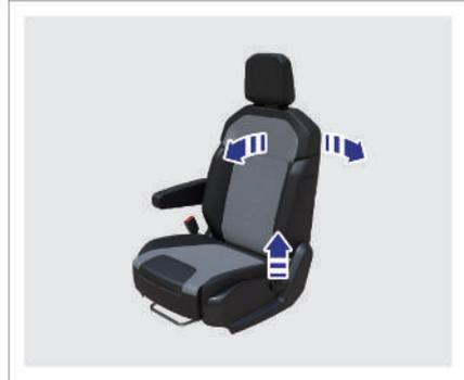
Heben Sie den Verstellhebel der Sitzlehne an, um die Rückenlehne zu entriegeln. Stellen Sie die Rückenlehne auf den gewünschten Winkel ein und senken Sie den Griff, um die Rückenlehne zu verriegeln.
