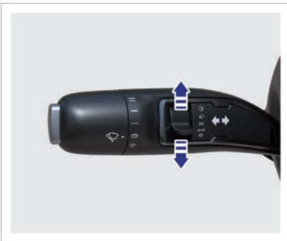
Der Kombinationsschalter befindet sich standardmäßig in der Position **AUTO**. Bei aktivierter Scheinwerferautomatik steuert das automatische Beleuchtungssystem das Ein- und Ausschalten der Scheinwerfer intelligent in Abhängigkeit von der
