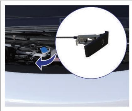
3. Ziehen Sie zweimal am Entriegelungsgriff der unteren Abdeckung im Motorraum, um die untere Abdeckung zu entriegeln;
