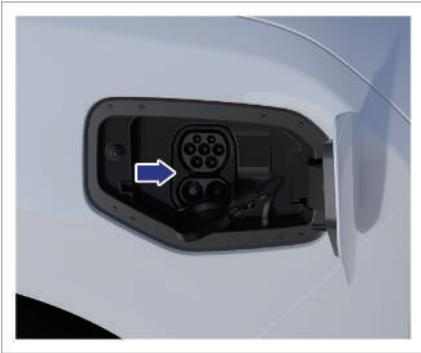
1. Öffnen Sie die Ladeklappe und entfernen Sie die obere Abdeckung des Ladeanschlusses und die untere Staubschutzabdeckung;
