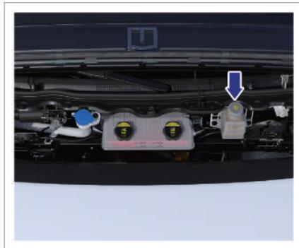
Der Behälter für die Bremsflüssigkeit befindet sich auf der linken Seite des Motorraums. Überprüfen Sie, ob der Flüssigkeitsstand im Behälter zwischen MIN und MAX liegt.
