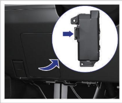
Der innere Sicherungskasten befindet sich auf der rechten Seite des Armaturenbretts. Verwenden Sie ein geeignetes Werkzeug, um den Deckel des Sicherungskastens aufzuhebeln und die Sicherung zu überprüfen.
