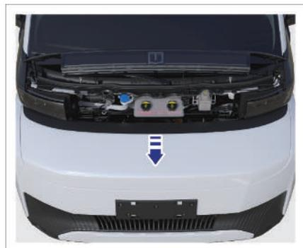
2. Drücken Sie die untere Abdeckung des Motorraums nach unten, um sie zu verriegeln.
