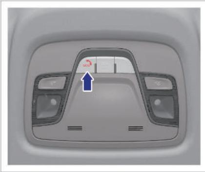
Das Auslösen des Airbags im Falle eines Aufpralls aktiviert automatisch ein Notfallsignal. Wenn die Fahrzeuginsassen einen Notdienst benötigen, drücken Sie die SOS-Taste im Bedienfeld über den Vordersitzen, um Hilfe zu rufen.
