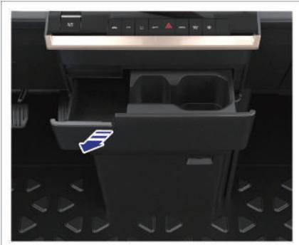
Der Getränkhalter in der Mittelkonsole befindet sich unter dem Bedienfeld der Klimaanlage. Er lässt sich öffnen, indem Sie ihn von der Mittelkonsole wegziehen. Er kann zur Aufbewahrung von Gegenständen oder Wasser in Flaschen verwendet werden.
