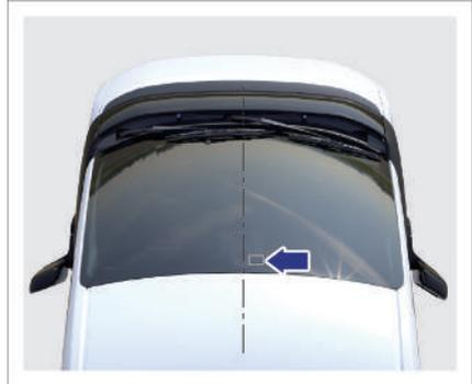
Der für die Mikrowellenstrahlung des Fahrzeugs vorgesehene Bereich befindet sich oben in der Mitte der Windschutzscheibe.
