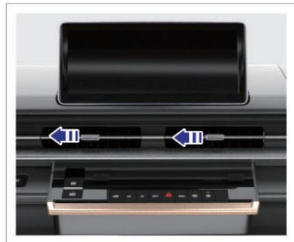
Schieben Sie den zentralen Schalter ganz nach links in die in der Abbildung gezeigte Richtung, um den Luftauslass zu schließen.
