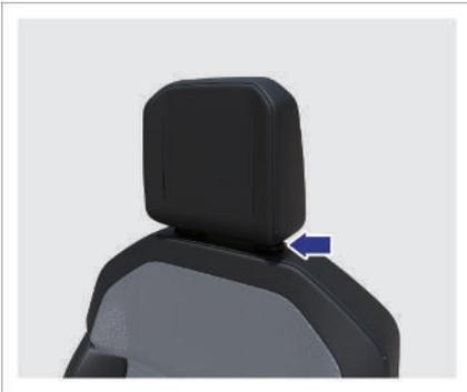
Wenn Sie die Kopfstützen nach oben verstellen möchten, ziehen Sie die Kopfstützen einfach nach oben. Wenn Sie die Kopfstützen nach unten verstellen, drücken Sie den Verstellknopf an der Seite der Kopfstütze des Sitzes und bewegen Sie die Kopfstütze in die gewünschte Position, bis ein Klickgeräusch zu hören ist, um sicherzustellen, dass die Kopfstütze eingerastet ist.
