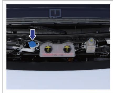
Der Waschflüssigkeitsbehälter befindet sich in der Mitte des vorderen Motorraums.
