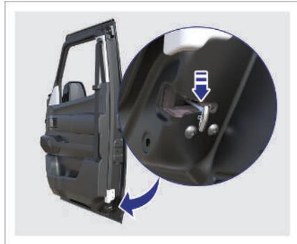
1. Zur Verriegelung der Beifahrertür: Stecken Sie den mechanischen Schlüssel in die Notverriegelungsöffnung des Beifahrertürschlosses, stellen Sie den Notverriegelungsschalter in die untere Position und schließen Sie anschließend die Tür.
