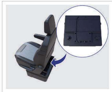
Die Niederspannungsbatterie befindet sich unter dem Fahrersitz. Sie können diese sehen, wenn Sie den Fahrersitz vollständig nach vorne schieben.
