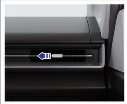
Schieben Sie den seitlichen Schalter zur Einstellung des Luftauslasses ganz nach links in die in der Abbildung gezeigte Richtung, um den Luftauslass zu schließen.
