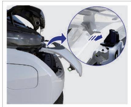
1. Setzen Sie die Führungselemente auf beiden Seiten der unteren Abdeckung des Motorraums in die Führungshalterung der unteren Abdeckung des Motorraums ein.
