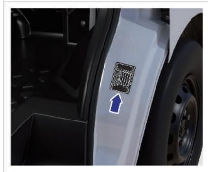
2. Vom Typenschild auf dem Schweller der Beifahrertür.
