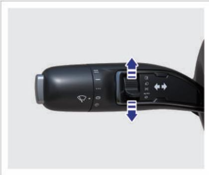
Schalten Sie den Kombinationsschalter auf die
