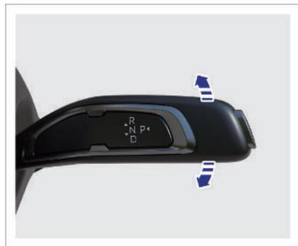
Der Wählmechanismus des Fahrzeugs ist als Säulen-Gangwahlhebel ausgeführt. Der Gangwahlhebel befindet sich auf der rechten Seite des Lenkrads. Er hat vier Gänge (Positionen), nämlich
