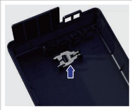
2. Entfernen Sie die Sicherung mit einem Sicherungszieher, indem Sie den Kopf der Sicherung in eine der Greiföffnungen des Werkzeugs einsetzen und vorsichtig herausziehen. Prüfen Sie, ob der Metalldraht durchgebrannt ist.
