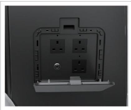
Der Laderaum ist mit drei dreipoligen 16A-Steckdosen ausgestattet. Der in der Antriebsbatterie gespeicherte Strom kann über die Steckdose im Laderaum mit 220 V entladen werden.
