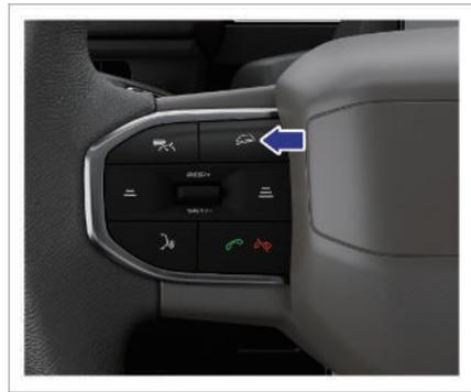
Um HDC zu aktivieren, drücken Sie die HDC-Taste auf der linken Seite des Lenkrads. Die HDC-Kontrollleuchte
