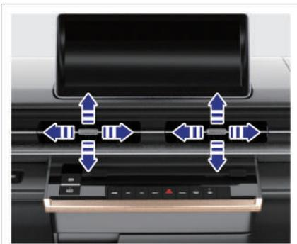
Schieben Sie die Einstellschalter in die in der Abbildung gezeigte Richtung, um die Ausblasrichtung der Luftauslässe einzustellen.
