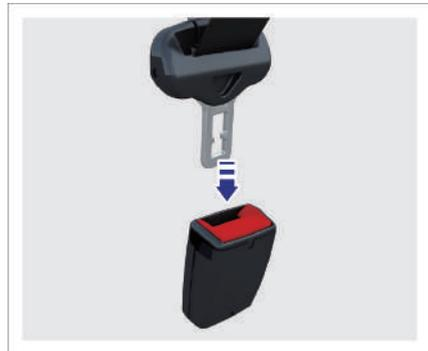
2. Drücken Sie die Gurtzunge in den Schlossmechanismus, bis ein „Klick“ zu hören ist. Ziehen Sie an der Gurtzunge, um sicherzustellen, dass sie verriegelt ist;
