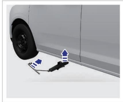
5. Die Wagenheber-Kurbel anbringen und im Uhrzeigersinn drehen, um das Fahrzeug ausreichend anzuheben, damit der defekte Reifen gewechselt werden kann.
