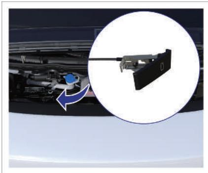
3. Ziehen Sie zweimal am Entriegelungsgriff der unteren Abdeckung im Motorraum, um die untere Abdeckung zu entriegeln;
