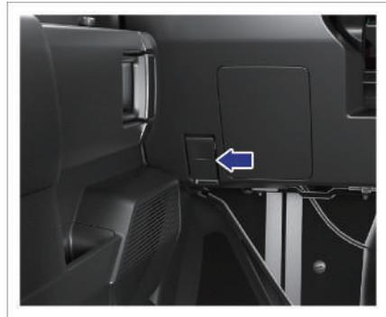
1. Ziehen Sie zweimal am Griff zum Öffnen der Motorhaube an der Armaturentafel des Fahrers, um die Motorhaube hochzuklappen;
