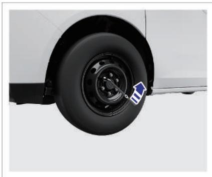
3. Stecken Sie den Radschlüssel auf die Radmuttern des Fahrzeugs und drehen Sie sie gegen den Uhrzeigersinn, um alle Muttern nur um etwa eine Umdrehung zu lösen, ohne sie zu entfernen;
