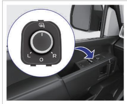
Stellen Sie den Einstellschalter für den Außenrückspiegel auf
