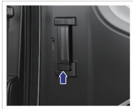
2. Verriegeln der seitlichen Schiebetür: Schieben Sie den Schalter für die Verriegelung der seitlichen Schiebetür nach links, um die seitliche Schiebetür zu verriegeln, und schließen Sie dann die seitliche Schiebetür.
