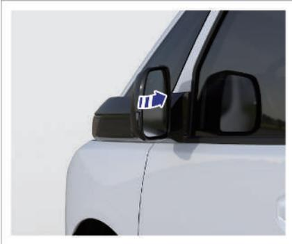
Drücken Sie den Außenrückspiegel manuell nach innen, um ihn einzuklappen. Drücken Sie den Außenrückspiegel manuell nach außen, um ihn auszuklappen.
