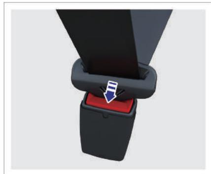
4. Drücken Sie den roten Knopf an der Gurtzunge, um den Sicherheitsgurt zu lösen. Der Sicherheitsgurt muss vor der Benutzung aufgerollt werden.
