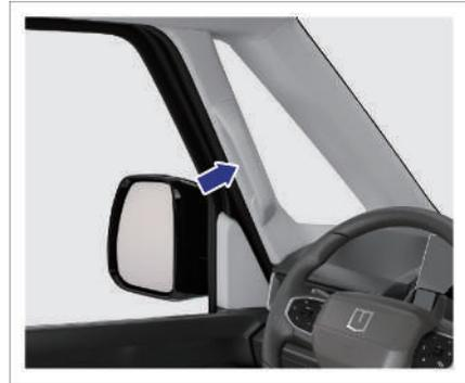
An der A-Säule auf der Fahrerseite und der Beifahrerseite sind Zusatzgriffe zum Einsteigen angebracht. Beim Einsteigen können sich Fahrer und Beifahrer an diesen Griffen festhalten, um sicher ins Fahrzeug zu gelangen.
