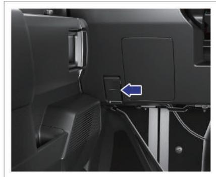
1. Ziehen Sie zweimal an dem Griff zum Öffnen des Motorraums, der sich unten links am Armaturenbrett auf der Fahrerseite befindet. Dann springt die Motorhaube nach oben auf.
