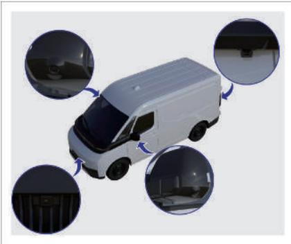
Die Kameras des AVM befinden sich am vorderen Stoßfänger, an den Außenrückspiegeln auf beiden Seiten und an der Seite der hinteren Kennzeichenleuchte.
