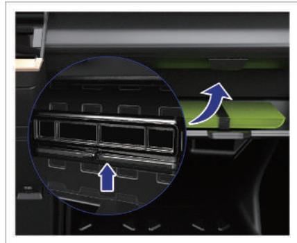
Der Klimaanlagefilter befindet sich auf der Rückseite des Handschuhfachs und kann Staub, Pollen und andere feine Partikel in der Außenluft wirksam abhalten und filtern.
