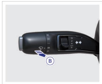
Bewegen Sie den Kombinationsschalter in Richtung B in die Mittelstellung, um das Fernlicht einzuschalten. Lassen Sie den Kombinationsschalter los, kehrt er automatisch in die Ausgangsposition zurück und das Fernlicht erlischt. Die Blinkfunktion des Fernlichts kann durch wiederholtes Ziehen des
