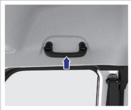
Auf der Beifahrerseite ist ein Innengriff angebracht, an dem der Beifahrer das Gleichgewicht halten kann.
