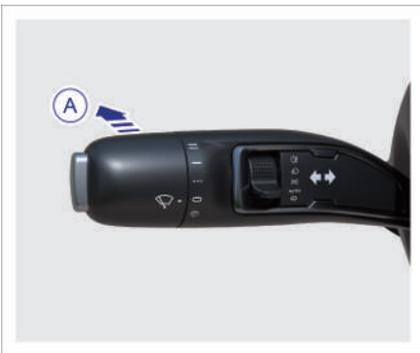
Wenn das Abblendlicht eingeschaltet ist, drücken Sie den Griff des Kombinationsschalters in die Endstellung in Richtung A, um das Fernlicht zu aktivieren. Wenn Sie den Griff des Kombinationsschalters wieder bis zum Endanschlag in Richtung A drücken, erlischt das Fernlicht. Der Kombinationsschalter kehrt automatisch in die
