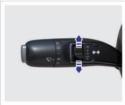
Schalten Sie den Kombinationsschalter auf die Position, wird das Abblendlicht aktiviert.
