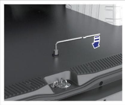
3. Drehen Sie die Stützschraube des Reserverads im Uhrzeigersinn und verwenden Sie das mitgelieferte Demontagewerkzeug, um das Reserverad anzuheben;
