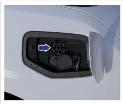
1. Öffnen Sie die Ladeklappe, und entfernen Sie die Staubschutzabdeckung vom Ladeanschluss;
