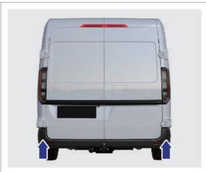
Die hinteren Millimeterwellen-Radare befinden sich auf beiden Seiten der hinteren Stoßstange des Fahrzeugs.
