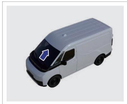
Die Frontkamera befindet sich im mittleren, oberen Bereich der Frontscheibe. Es sammelt Umgebungsinformationen in Echtzeit, je nach Bedarf des Fahrers.
