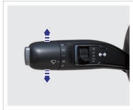
Wenn Sie den Griff des Kombinationsschalters vorsichtig nach oben/unten in die erste Position bewegen und loslassen, kehrt der Griff des Kombinationsschalters automatisch zurück und der rechte/linke Blinker blinkt dreimal.
