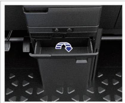
Das Staufach in der Mittelkonsole befindet sich unter dem Getränkhalter der Mittelkonsole. Es wird durch Klappen entsprechend der Pfeilrichtung geöffnet bzw. geschlossen.
