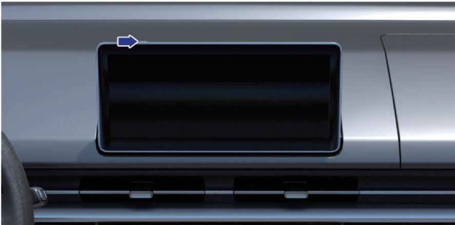
Oben links auf dem Multimedia-Display befindet sich eine POWER-Taste (Pfeil in der Abbildung). Drücken Sie diese Taste kurz, um den Bildschirm zu entsperren/zu sperren; halten Sie diese Taste gedrückt, um das Multimediasystem neu zu starten.
