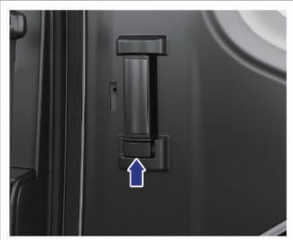
Schließen Sie die seitliche Schiebetür und betätigen Sie den Verriegelungsschalter, indem Sie ihn nach links schieben. Um sie zu entriegeln, schieben Sie den Schalter für die Schiebetürverriegelung nach rechts.
