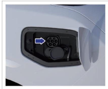
1. Öffnen Sie die Ladeklappe, und entfernen Sie die Staubschutzabdeckung vom Ladeanschluss;
