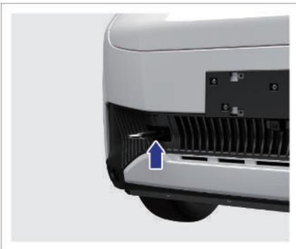
2. Nehmen Sie die Abschleppöse aus dem Werkzeugkasten des Fahrzeugs, schrauben Sie sie in das Befestigungsloch und ziehen Sie sie im Uhrzeigersinn fest.
