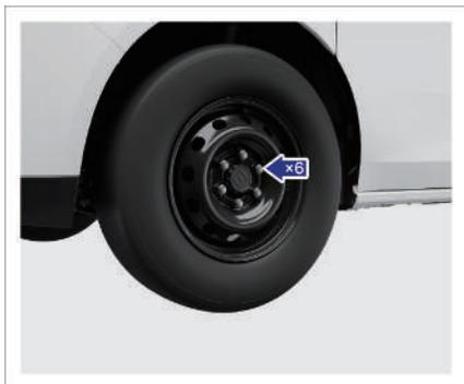
2. Entfernen Sie die Abdeckungen von 6 Fahrzeugradmuttern;
