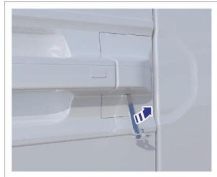
2. Stecken Sie den mechanischen Schlüssel in die Öffnung der Abdeckung am Fahrertürschloss, hebeln Sie sie vorsichtig an und nehmen Sie sie ab.
