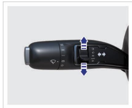
Schalten Sie den Kombinationsschalter auf die
