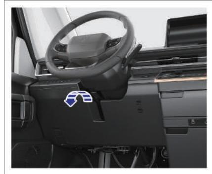
Der Hebel für die Lenkradeinstellung befindet sich unter dem Lenkrad.
