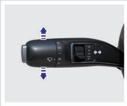
Wenn der Griff des Kombinationsschalters nach oben/unten bewegt wird, blinkt der rechte/linke Blinker. Bewegen Sie den Griff des Kombinationsschalters nach dem Abbiegen in die mittlere Position. Der Blinker auf der entsprechenden Seite wird dann ausgeschaltet oder schaltet sich automatisch aus, wenn Sie das Lenkrad zurückdrehen.
