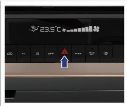
In besonderen Fällen, in denen das Fahrzeug in einem Notfall abgebremst oder angehalten werden muss, drücken Sie den Schalter für die Warnblinkanlage. Die Kontrollleuchte am Schalter blinkt zusammen mit den äußeren linken und rechten Blinkleuchten, um andere Verkehrsteilnehmer zu warnen. Um diese Lampen auszuschalten, drücken Sie den Schalter für die Warnblinkanlage erneut.
