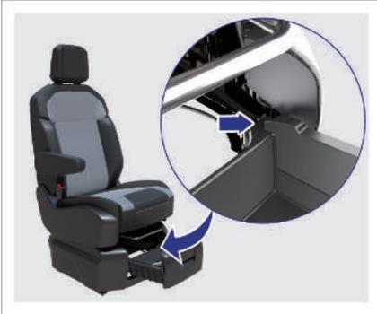
Sie können es wieder einbauen, indem Sie es an der Gleitschiene unter den Sitzen ausrichten und schräg nach innen drücken. Nachdem es installiert ist, kann es geschlossen werden, indem Sie flach nach innen zurückschieben.
