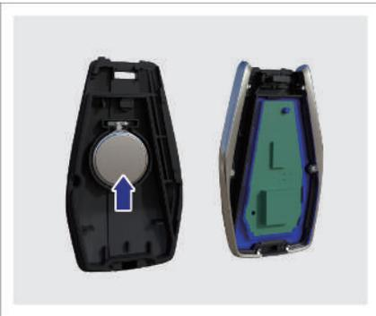
2. Setzen Sie die Batterie wieder ein und achten Sie darauf, dass der Pluspol richtig ausgerichtet ist.
