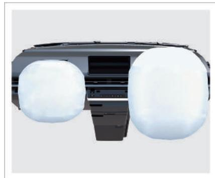
Die obige Abbildung zeigt den Einsatzbereich während der Entfaltung des Airbags (Entfaltungszone). Lagern oder
