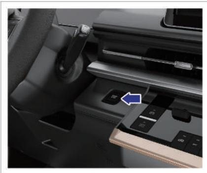
Der Startschalter des Fahrzeugs wird per Knopfdruck aktiviert. Stellen Sie vor dem Starten des Fahrzeugs sicher, dass sich der mit dem Fahrzeug kompatible Funkschlüssel im Fahrzeug befindet und vom System erkannt werden kann.
