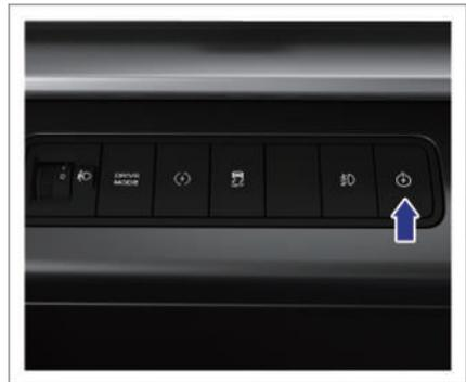
3. Drücken Sie die Entladetaste auf dem linken Schaltmodul des Armaturenbretts. Wenn die grüne Arbeitsstatusanzeige aufleuchtet, beginnt das Fahrzeug mit der Entladung, und der Stecker wird sofort verriegelt.
