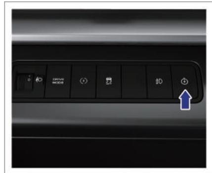
2. Öffnen Sie die Abdeckung der Steckdose im Laderaum und drücken Sie die Entladetaste (Pfeil in der Abbildung). Dann leuchtet die Betriebsanzeige auf.
