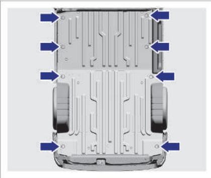
Im Laderaum befinden sich acht Befestigungsringe zur Sicherung der Ladung. Wenn Sie Befestigungsringe verwenden, hebeln Sie diese zunächst mit einem Werkzeug in den richtigen Winkel und drehen Sie sie dann manuell in die gewünschte Position. Bitte legen Sie die Befestigungsringe nach dem Gebrauch flach hin.
