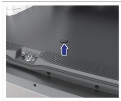
1. Öffnen Sie die Hecktür und verwenden Sie ein geeignetes Werkzeug, um die Abdeckplatte des Ersatzrad-Schraublochs zu entfernen;
