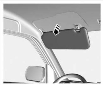
Die Sonnenblende kann aus der Klemme an einer Seite herausgezogen werden. Anschließend kann die Sonnenblende zur Seite gedreht werden, um Blendung durch seitlich einfallendes Sonnenlicht zu verringern.
