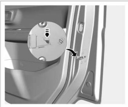
4. Verriegeln Sie als letzten Schritt die Fahrertür mit dem mechanischen Schlüssel.
