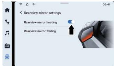
Bei schlechtem Wetter wie Regen, starkem Nebel und Kälte kann die Rückspiegeloberfläche durch Nebel, Frost und Schnee benetzt werden. Die Heizfunktion kann eingeschaltet werden, um Regen, Schnee oder Reif auf der Spiegeloberfläche zu
