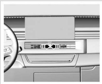
Zum Schließen der mittleren Luftauslässe bewegen Sie die beiden Einstellhebel aufeinander zu.
