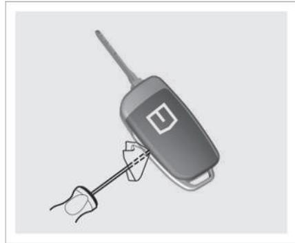
2. Entfernen Sie die Montageplatte des Funkschlüssels und ersetzen Sie diese durch eine neue. Setzen Sie die Batterie richtig herum ein, so wie es auf dem Schaltkreis angegeben ist. Batteriemodell für Fernbedienungsschlüssel: 3 V, CR2032.
