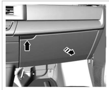
Das Handschuhfach befindet sich auf der Beifahrerseite der Instrumententafel. Drücken Sie auf die Taste des Handschuhfachs, um dieses zu öffnen. Drücken Sie das Handschuhfach zum Schließen nach innen
