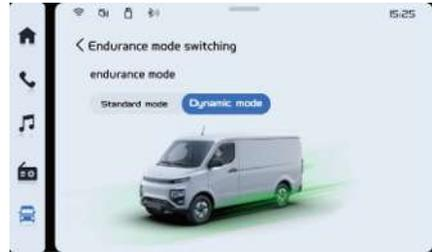
Im Standard-Modus wird die Reichweite auf der Grundlage des durchschnittlichen Gesamtenergieverbrauchs des Fahrzeugs berechnet; im Dynamik-Modus wird die Reichweite auf der Grundlage des dynamischen Energieverbrauchs berechnet, der sich aus den aktuellen Fahrgewohnheiten ergibt. Die in diesem Modus angezeigte Reichweite liegt relativ nahe an der tatsächlichen Reichweite.
