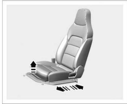
Ziehen Sie am Hebel zur Vorwärts-/Rückwärtsverstellung des Sitzes, schieben Sie den Sitz in die gewünschte Position und lassen Sie dann den Hebel los.
