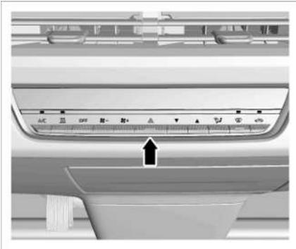
Drücken Sie den Schalter für die Warnblinkanlage. Jetzt blinken die Anzeige des Kombiinstruments und die äußeren Blinker gleichzeitig, um andere Verkehrsteilnehmer zu warnen. Drücken Sie den Warnblinkschalter erneut, um die Warnblinkanlage auszuschalten.
