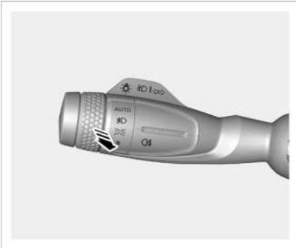
Ziehen Sie den Licht-Lenkstockhebel in Richtung Ihres Körpers, um das Fernlicht einzuschalten. Nach dem Loslassen kehrt der Licht-Lenkstockhebel automatisch in seine ursprüngliche Position zurück und das Fernlicht wird automatisch ausgeschaltet. Betätigen Sie die Lichthupe wiederholt, um andere Verkehrsteilnehmer aufmerksam zu machen.
