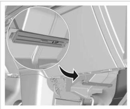
Der Klimaanlagenfilter befindet sich hinter dem Handschuhfach. Der Filter kann extrem kleine Partikel wie Staub, Pollen und Staub effektiv daran hindern, in das Fahrzeuginnere zu gelangen.
