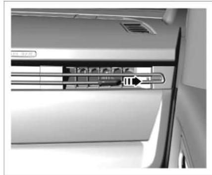
Zum Schließen der äußeren Luftauslässe bewegen Sie den Einstellhebel nach aussen.
