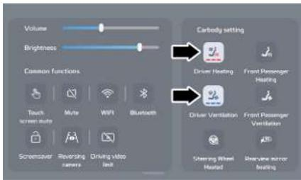
Sie können auch das Menü oben auf dem Bildschirm durch Herunterziehen öffnen und die entsprechende Schaltfläche wählen, um die Lüftungs- oder Heizfunktion einzuschalten.
