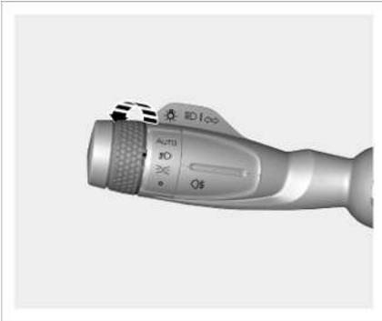
Stellen Sie den Schalter auf die Position
