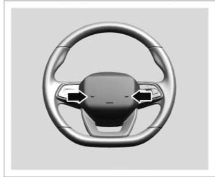
Drücken Sie auf den Bereich des Hupensymbols am Lenkrad um die Hupe zu betätigen.
