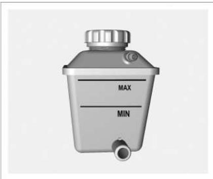
**!** Um Verbrühungen zu vermeiden, darf der Druckdeckel des Kühlmittelausgleichsbehälters erst nach dem vollständigen Abkühlen des Kühlmittels geöffnet werden.
