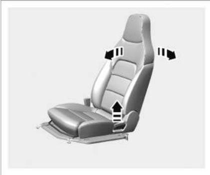
Wenn die Neigung der Rückenlehne verstellt werden muss, ziehen Sie am Hebel für die Neigungsverstellung der Rückenlehne, um die Rückenlehne zu entriegeln. Nachdem die Rückenlehne in die gewünschte Position gebracht wurde, lassen Sie den Griff los, um die Rückenlehne zu verriegeln.
