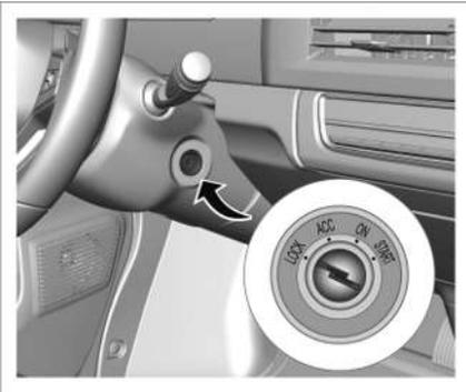
Stecken Sie den Schlüssel in den Zündschlosszylinder und drehen Sie ihn in verschiedene Positionen.
