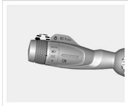
Drehen Sie den Schalter oben am Licht-Lenkstockhebel in die
