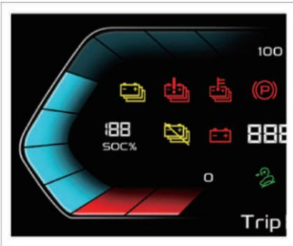
Die Obergrenze der Ladezustandsanzeige liegt bei 100%, die Untergrenze bei 0. Insgesamt gibt es 10 Zellen; die oberen 8 Zellen werden in Blau und die unteren 2 Zellen in Rot angezeigt. Wenn der Ladezustand der Antriebsbatterie weniger als 20 % beträgt, wird die Ladezustandsanzeige rot und die Anzeige für niedrigen Ladezustand leuchtet auf. Bitte laden Sie Ihr Fahrzeug rechtzeitig auf.
