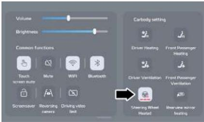
Sie können auch das Menü oben auf dem Bildschirm durch Herunterziehen öffnen und zum Einstellen auf das Symbol „Lenkradheizung“ tippen.
