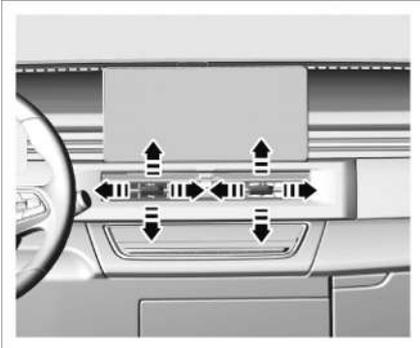
Bewegen Sie den mittleren Einstellhebel des Luftauslasses nach oben, unten, links und rechts, um die Blasrichtung der Luft anzupassen.
