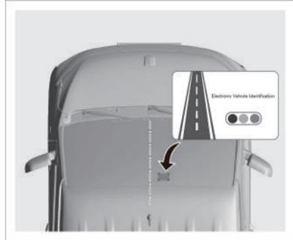
Der für die Mikrowellenstrahlung des Fahrzeugs vorgesehene Bereich befindet sich oben rechts in der Mitte der Windschutzscheibe.
