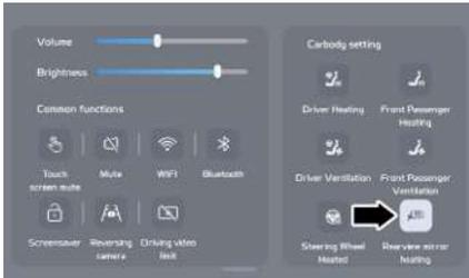
Sie können auch das Menü oben auf dem Bildschirm durch Herunterziehen öffnen und auf das Symbol für die Rückspiegelheizung tippen, um die Funktion zu aktivieren.
