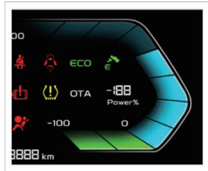
Die Obergrenze des Leistungsmessers liegt bei 100%, die Untergrenze bei -100%. Insgesamt gibt es 10 Zellen; die oberen 8 Zellen werden in blau angezeigt und zeigen die Leistungsabgabe an. Die unteren beiden Zellen werden in grün angezeigt und symbolisieren den Rekuperationsbetrieb. Aktuell wird der Wert negativ angezeigt.
