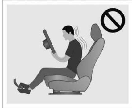
Nachdem Sie den Sicherheitsgurt angelegt haben, werden Sie mit dem Fahrzeug zusammen abgebremst. Nun steht für das Abbremsen der Bewegung mehr Zeit und Raum zur Verfügung. Gleichzeitig werden die Kräfte durch die stärksten Knochen im Körper aufgenommen. Aus diesem Grund spielt der Sicherheitsgurt eine sehr wichtige Rolle.
