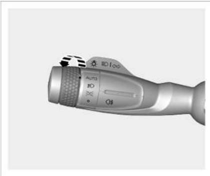
Drehen Sie den Schalter oben am Licht-Lenkstockhebel auf die Position AUTO und schalten Sie die Scheinwerferautomatik ein. Die Scheinwerferautomatik automatisiert das Ein- und Ausschalten der Scheinwerfer in Abhängigkeit der äußeren Beleuchtungsintensität. Wenn die äußere Umgebung aufgrund von
